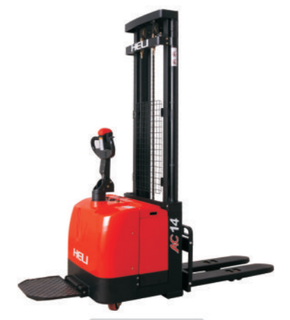
CDD14-930 1400Kg Narrow Legs /2-Stage Mast
