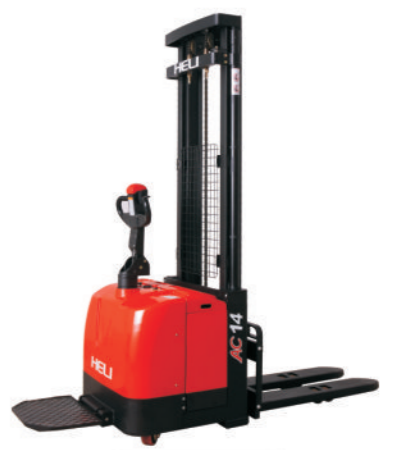
CDD14-930 1400Kg Narrow Legs /2-Stage Mast
